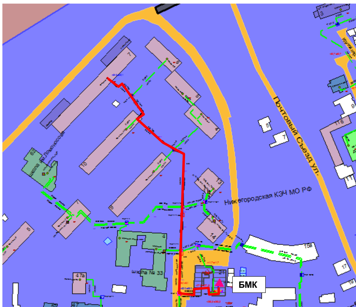
Рисунок Ошибка! Текст указанного стиля в документе отсутствует..11 – Результат гидравлического расчета - расчетный путь теплоносителя от от котельной Суетинская, 21 до ПТ-Федор,7
