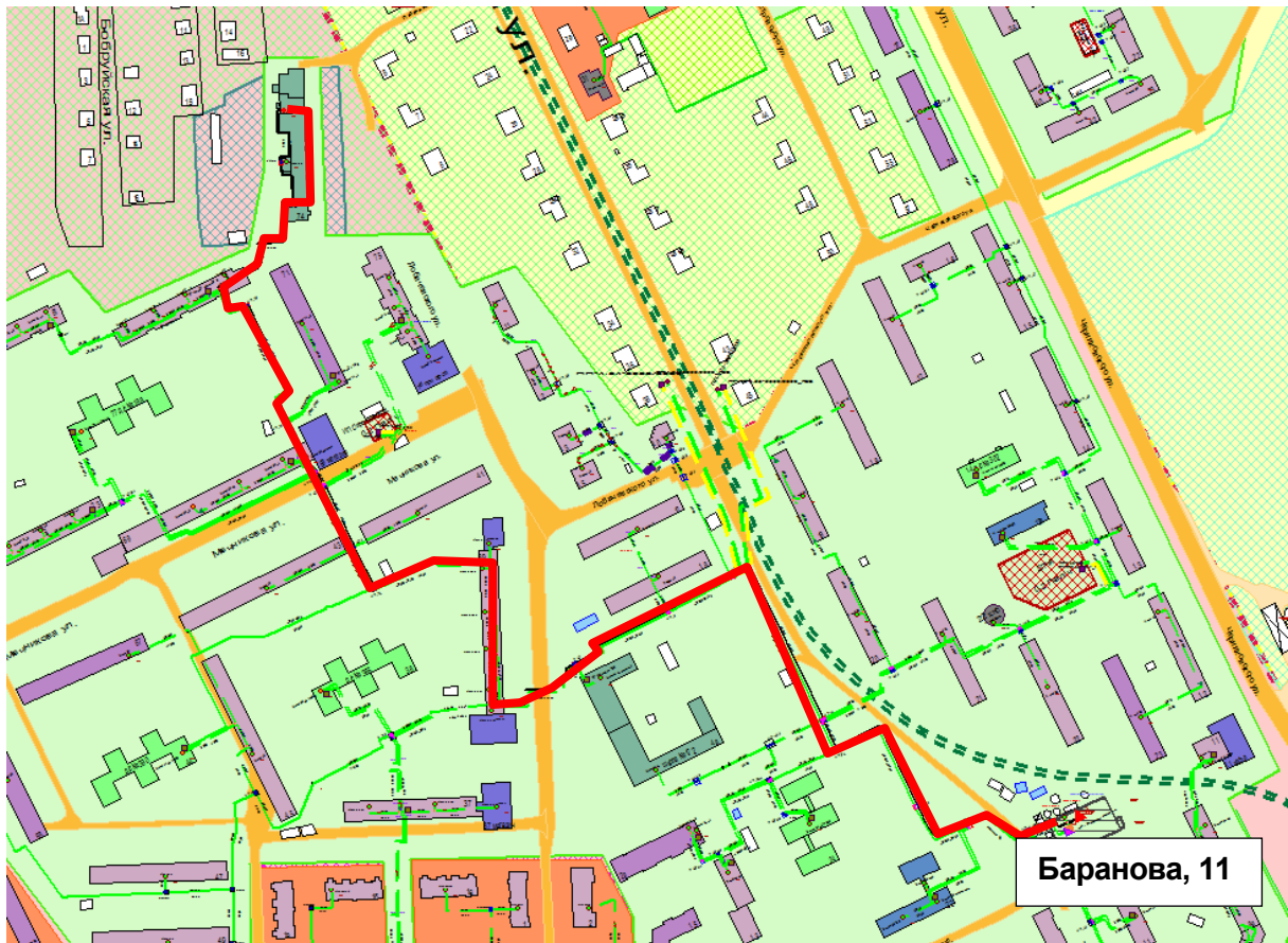
Рисунок Ошибка! Текст указанного стиля в документе отсутствует..25 – Результат гидравлического расчета - расчетный путь теплоносителя от котельной Баранова, 11 до ПТ-Мечн, 74 маст
